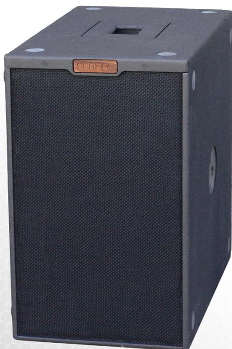
VS12A представляет собой сабвуфер, оснащенный встроенным 3-канальным усилителем мощности класса D. Питание усилителя имеет коррекцию коэффициента мощности, а его сигнальная схема дополнена продвинутым DSP-модулем Analog Devices, который имеет предустановки кроссовера, эквалайзера, задержки, ограничения сигнала и защиты от перегрузки.
